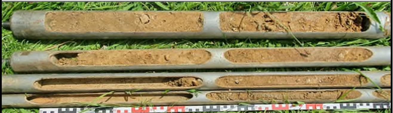
**Bild 2:** Rammkernsondierung 1, erster, zweiter, dritter und fünfter Meter von oben nach unten
