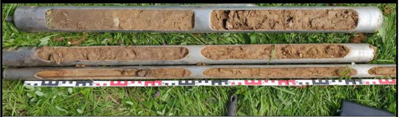
**Bild 7:** Rammkernsondierung 3, erster, zweiter und dritter Meter von oben nach unten
