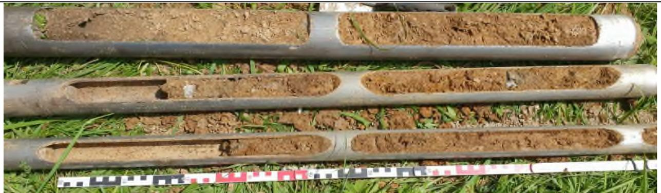
**Bild 5:** Rammkernsondierung 2, erster, zweiter und dritter Meter von oben nach unten
