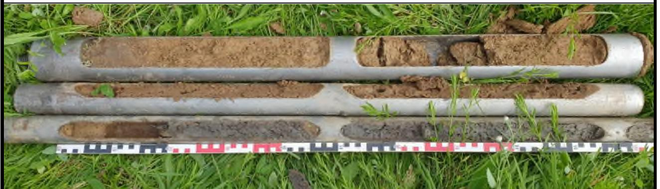
**Bild 9:** Rammkernsondierung 4, erster, zweiter und dritter Meter von oben nach unten
