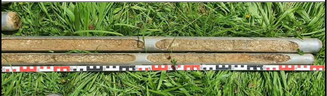
**Bild 3:** Rammkernsondierung 1, vierter und sechster Meter
