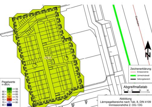
Abbildung 2: Lärmpegelbereiche nach Tabelle 8 der DIN 4109 (Immissionsschutzziele 2. OGDG) bei freier Schallschleierung (urn:mast:031)
