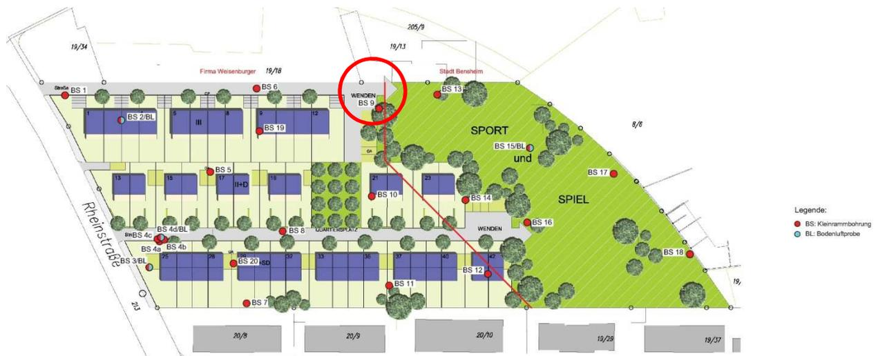
Abbildung 5 Lageplan der Probenahmepunkte (Quelle: „Umwelttechnisches Gutachten: Bauvorhaben Umnutzung ehemaliges MOB-Depot“ der GHJ Ingenieurgesellschaft für Geo- und Umwelttechnik mbH & Co. KG vom 07. Juli 2011; unmaßstäblich)
