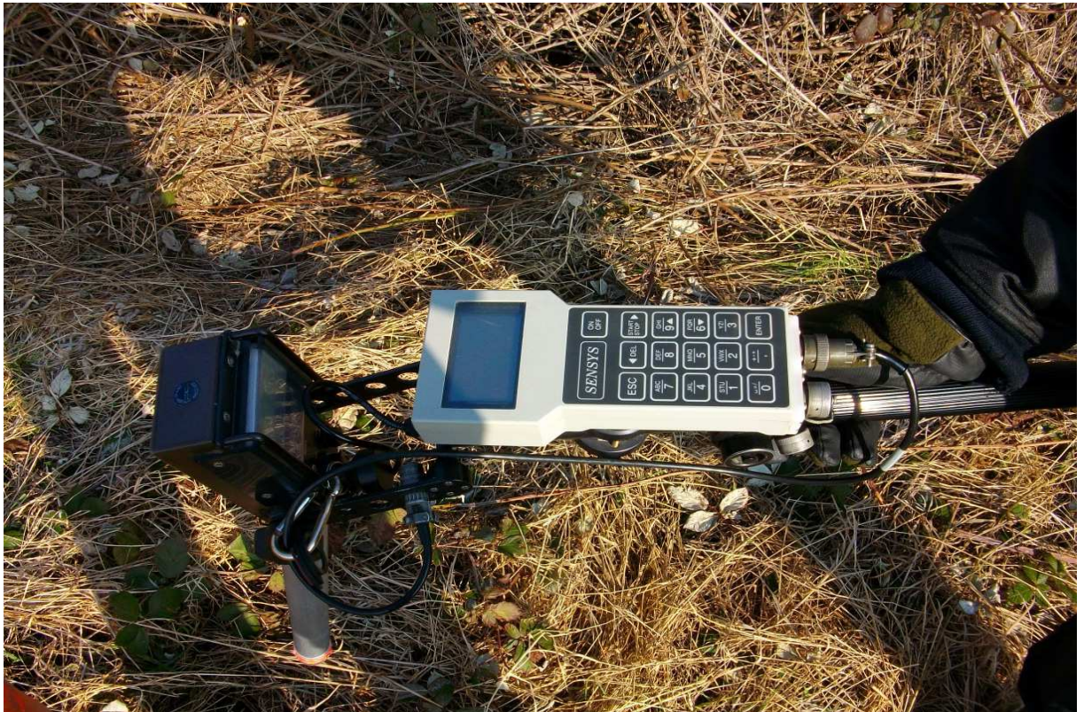
Foto 1 Situation 17.10.11. Kampfmitteltechnische Erkundung der 17 Bohrpunkte mittels Elektromagnetik (Ausführung: Büro Göttig, Worms).
