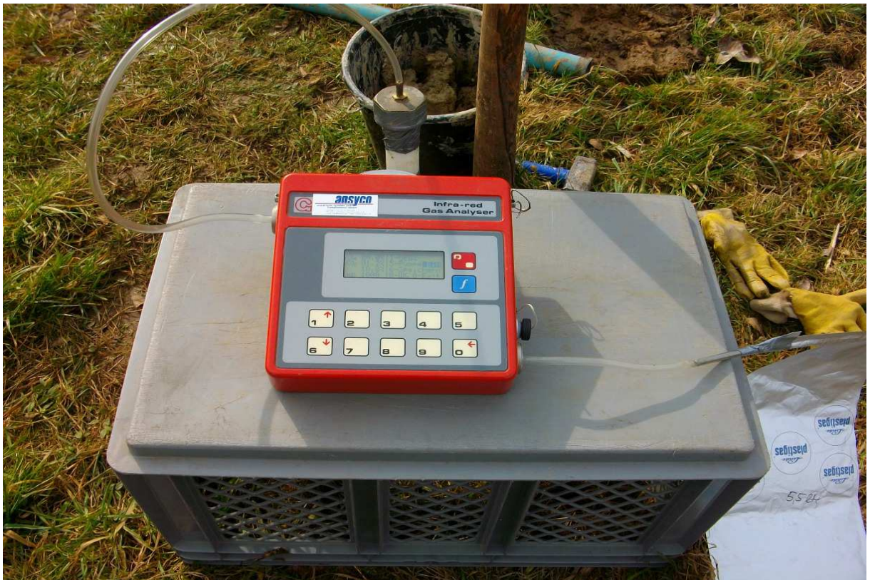
Foto 6 Messbetriebszustand mit PVC-Vollrohr, Gewindeverschlusskupplung und Infrarot-Gasanalysator. Über eine integrierte Pumpe werden 20 Liter Bodenluft abgesaugt, mit der ein gasdichter, mit Aluminium kaschierter Kunststoffbeutel befüllt wird (Bildrand rechts unten).
