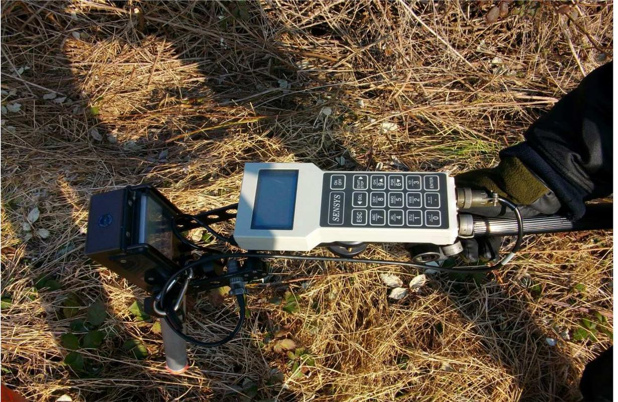
**Foto 1** Situation 17.10.11. Kampfmitteltechnische Erkundung der 17 Bohrpunkte mittels Elektromagnetik (Ausführung: Büro Götting, Worms).
